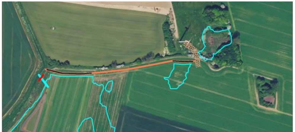
Figur 4-4 Dige (okker) med lerkerne (sort) ved Forslag A sikrer, at matr. 10a ikke oversvømmes. Den røde streg viser spanget over det nye indløb. Øst for diget er vist terrænregulering til samme højde som diget. Bredden af diget varierer med højden (ikke vist).
